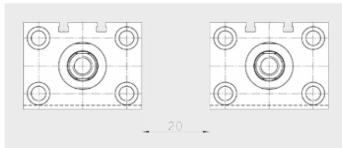
Se il cilindro magnetico è posizionato nell'incavo di un sistema ferroso ad assorbimento magnetico, mantenere una distanza minima di almeno 20 mm tra l'ingombro esterno del cilindro e la parete metallica immediatamente più vicina (esclusa parete di fissaggio), onde evitare la deformazione del campo magnetico ed il conseguente mancato azionamento dei sensori.
