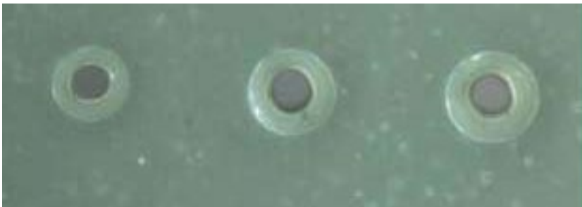
Foro da 0,005 mm eseguito di laser
