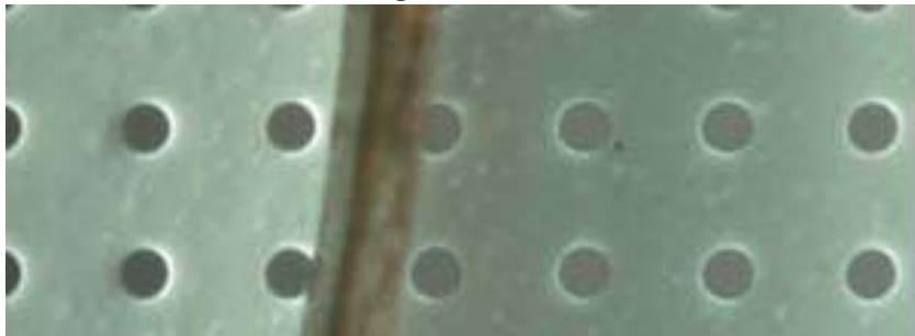
Foro da 0,005 mm tranciato con punzone in metallo duro e relativo confronto con capello umano
