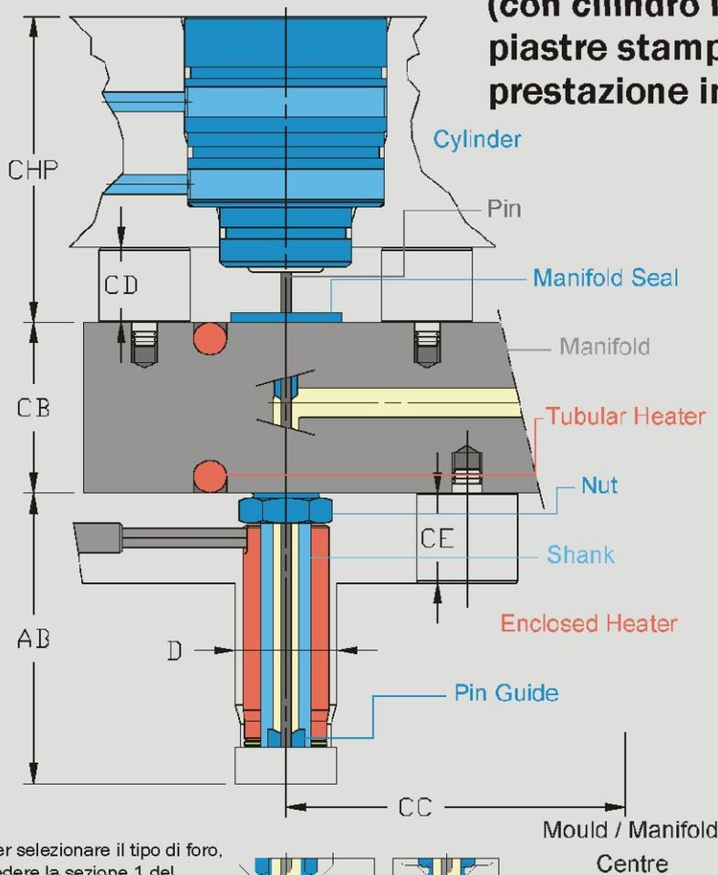
Per selezionare il tipo di foro, vedere la sezione 1 del Catalogo "Guida agli ugelli", per dimensioni costruttive vedere pagina seguente.
