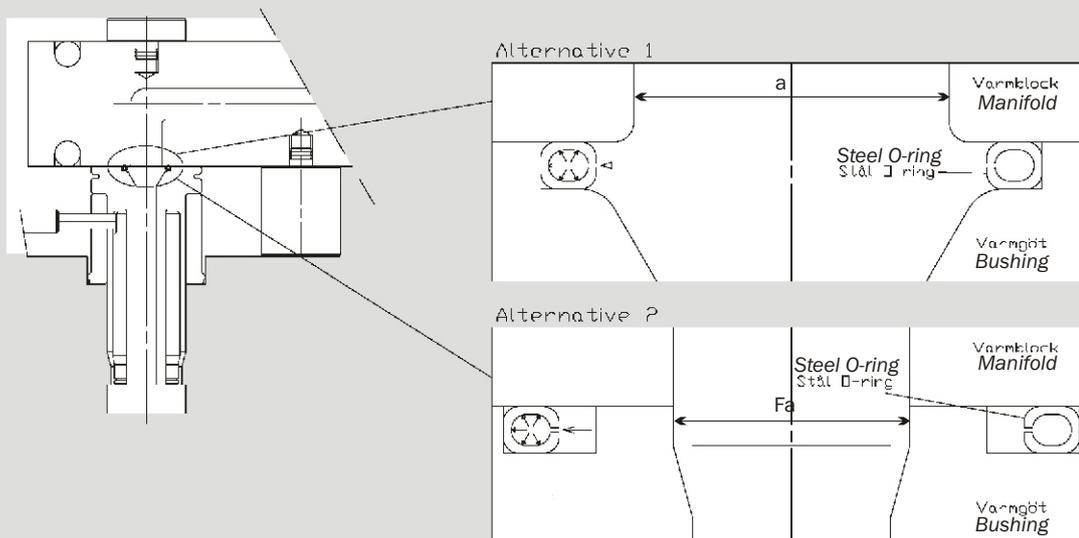
Le guarnizioni OR in acciaio MFO si usano su applicazioni con sistemi MFF (ugello in appoggio sul distributore).
