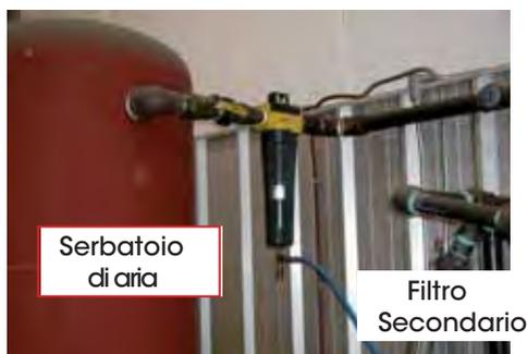
Per portare l'aria pulita sino al mandrino, può essere utile l'inserimento di un solenoide. L'aria contaminata danneggia l'apparecchio. Assicuratevi che l'aria sia pulita ed asciutta.
