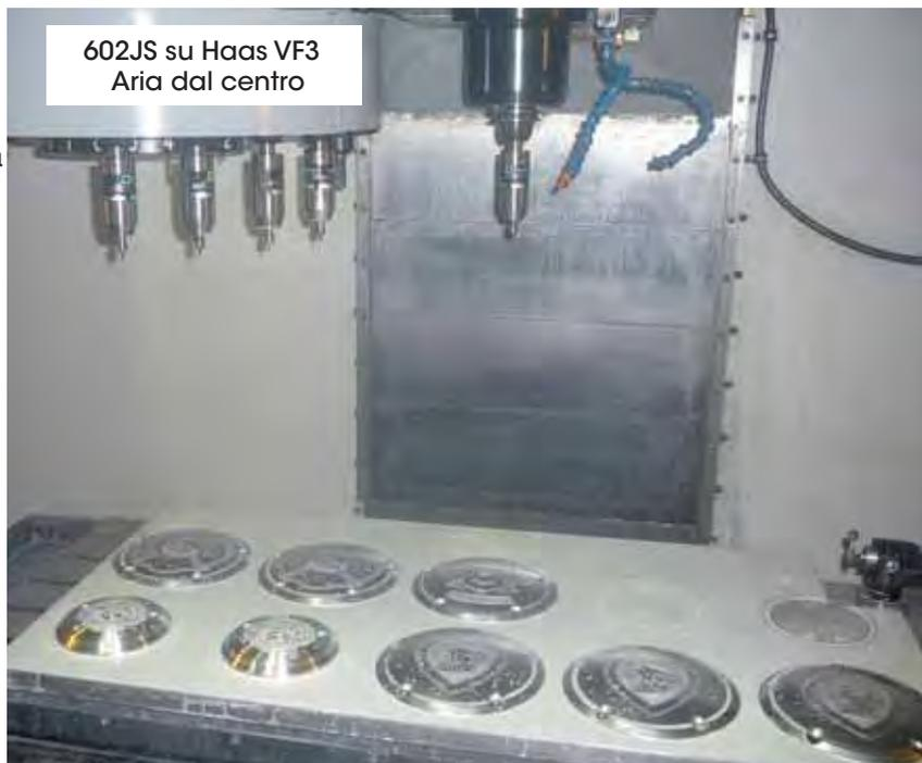
Nella figura a lato, si sta lavorando AISI 304 con una fresa di  $\varnothing 0,15$  ed una profondità di taglio di 0,015. Fresano anche l'alluminio 6061 con avanzamenti di 400 mm/min con una fresa ad un tagliante.
