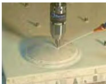
L'apparecchio 602 è disponibile con turbina semplice o doppia. La capacità massima del gambo utensile è 3 mm. (pinza ER8). Il 602 X con 0,3 KW è disponibile con pinze ER11.
