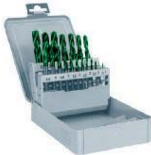
Punte elicoidali per uso universale, stabili e robuste con rilevante resistenza al calore. Particolarmente adatte per acciai fino a R 1000 N/mm<sup>2</sup>, ghise, leghe di AISI e per l'uso professionale su trapani a mano. (foratura a secco).
