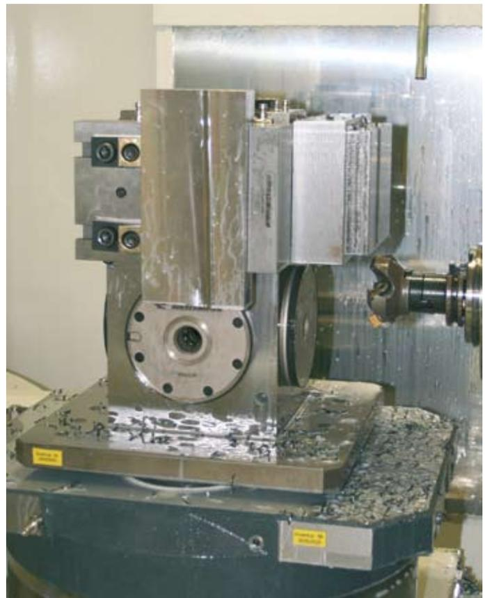
**Pneumatische und hydraulische Einbauspanner H9003.... - (Ø 129 mm)**
