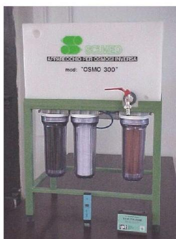
**NOTE: E' bene considerare che il caricamento/rabbocco delle vasche EDWM con acqua deionizzata anziche di rete, può ridurre del 50% il consumo delle resine a scambio ionico della macchina stessa.**
