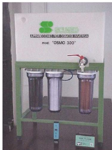
**NOTE: E' bene considerare che il caricamento/rabbocco delle vasche EDWM con acqua deionizzata anziché di rete, può ridurre del 50% il consumo delle resine a scambio ionico della macchina stessa.**
