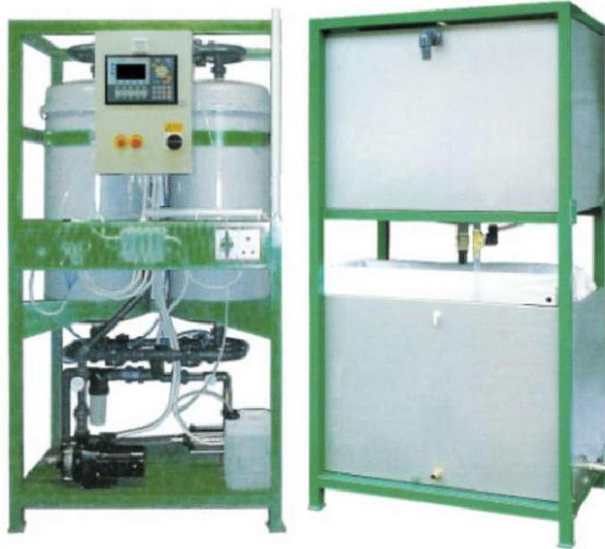
**WEEFS** è il moderno sistema di filtrazione che risolve i problemi delle EDM a filo.
